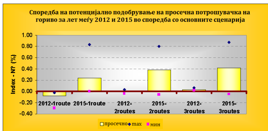
Слика 6.32: Просечна промена на потрошувачката на гориво за лет во различни ситуации на сообраќај
