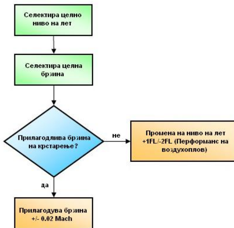
Слика 5.5: Структура на алгоритам на време на летот на воздухопловот
