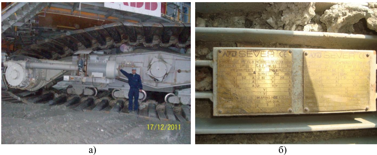
Слика 7.3. Надворешен изглед на погонот за транспорт на багерот а) и изглед на табличката на асинхрониот мотор од транспортот б)
