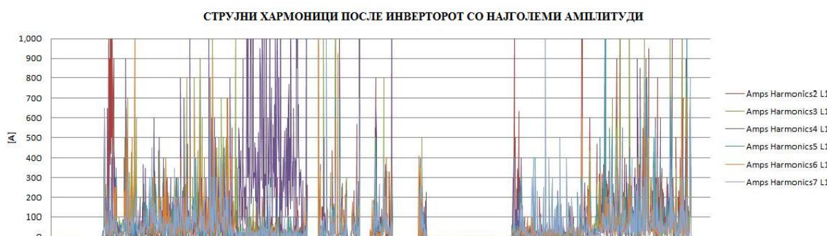
Слика 7.32. Хармоници со најголеми струјни амплитуди
