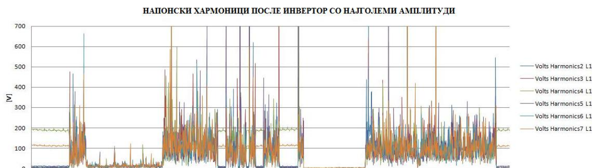
Слика 7.31. Хармоници со најголеми напонски амплитуди
