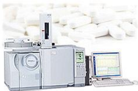
Слика 5. Гасен хроматограф поврзан со масен спектрометар
