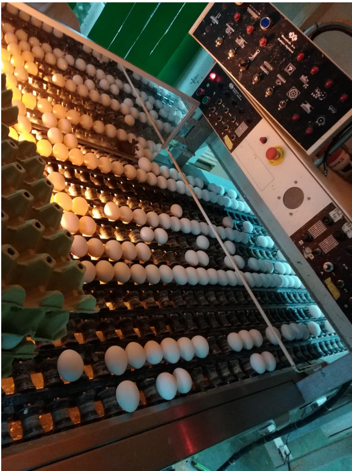
Слика бр.3 Потполно механизирана проверка на физичко-хемиската исправност јајцата 2 дел („Везе Шари“ с. Требош – Тетово)
