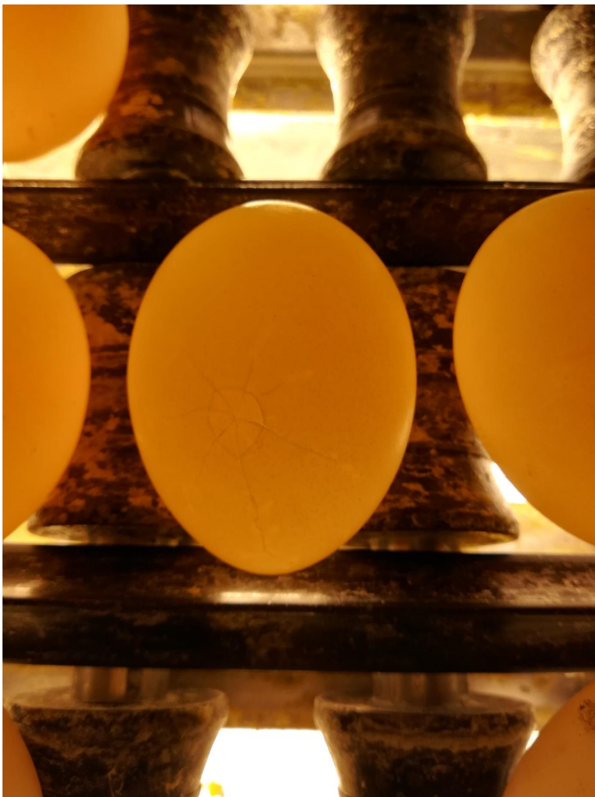
Слика бр.4 Потполно механизирана проверка на физичко-хемиската исправност на јајцата со светлосен метод и откривање на повреди на лушпата на јајцето 3 дел („Везе Шари“ с. Требош – Тетово)
