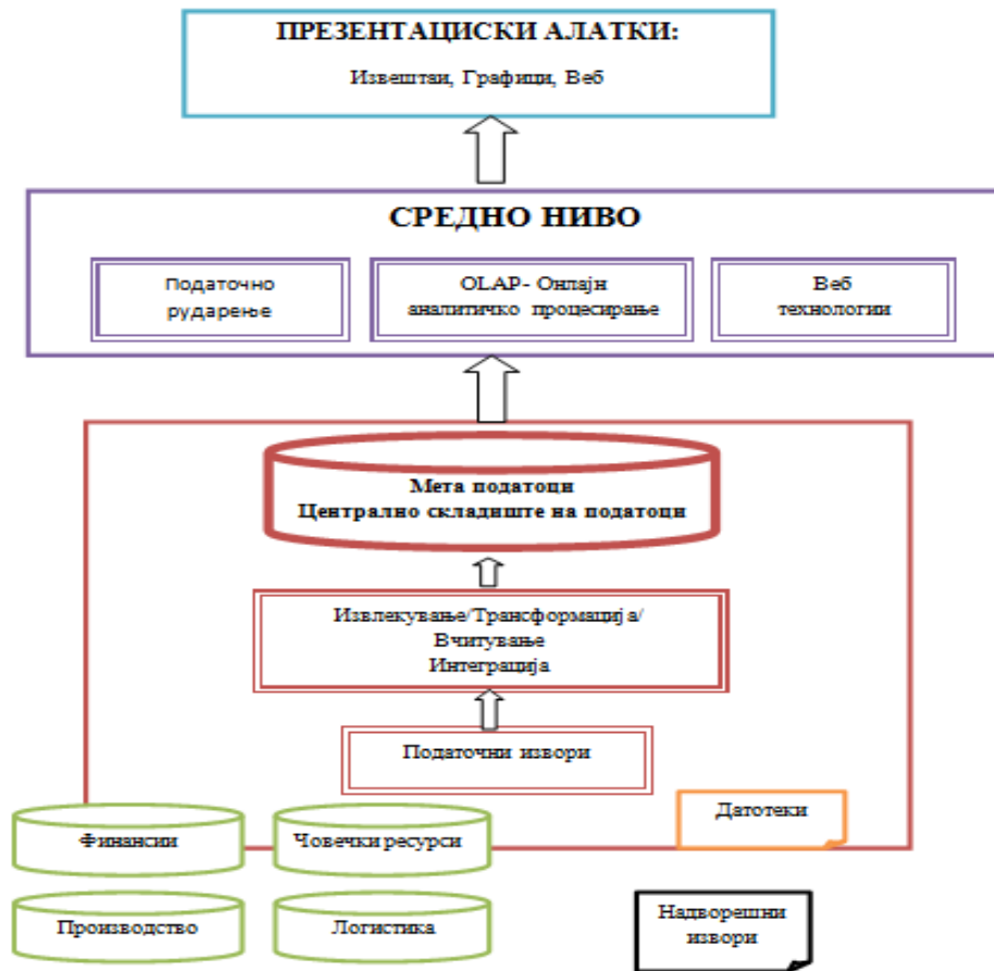
Слика 3.2. Архитектура на ИИС систем
