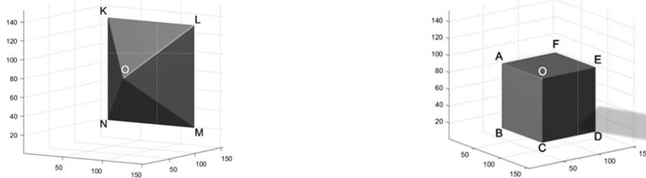
Рисунок 5 - Два типа трехмерных углов, вершина O является центром массива. (а) Фигура OKLMN – пирамида, (б) фигура OABCDEF – октант.
