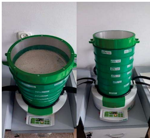
Слика бр. 7: Апарат за определување гранулометриски состав на брашното LPzE-2e MultiserW Morek
