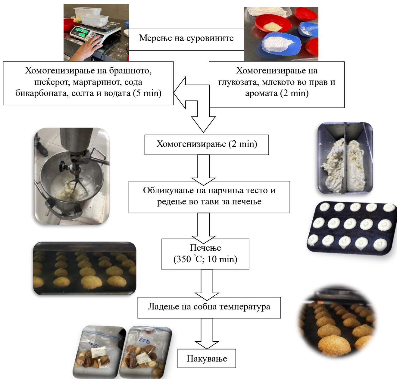
Слика 1: Шематски приказ на производство на кексите
