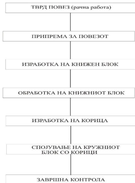
Слика 12. Шема на тврдо побрзување – рачна изработка
