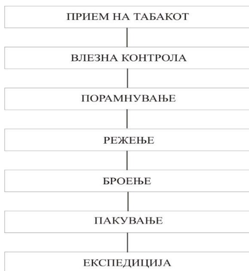
Слика 9. Технолошки процес на изработка на плакат
