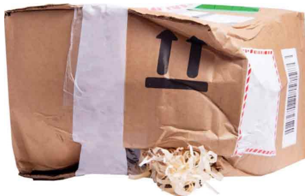
Слика бр. 13 Транспортна амбалажа од брановидна лепенка уништена од механички сили
