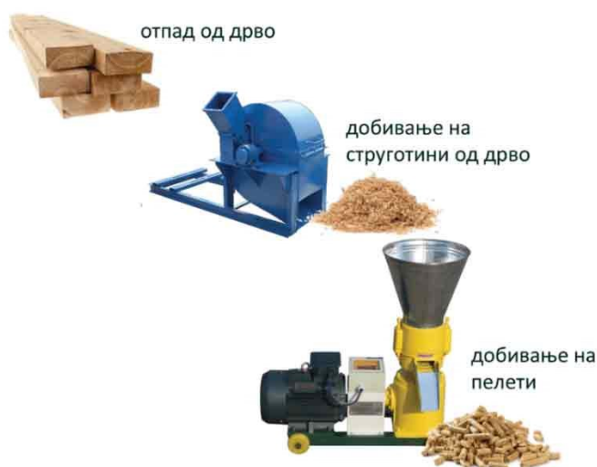
Слика бр. 50 Добивање на пелети
